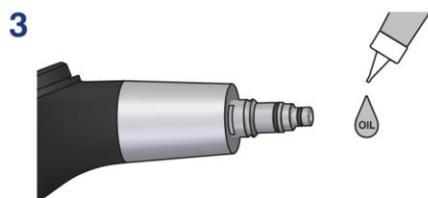
Просушите область O-образного кольца резервуара порошка, добавьте каплю турбинного масла и протрите вручную.
