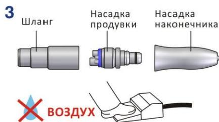
Прикрепите насадку продувки к шлангу и соедините с насадкой наконечника. Включите холостой ход без воды минимум на 5 секунд для очистки каналов.
