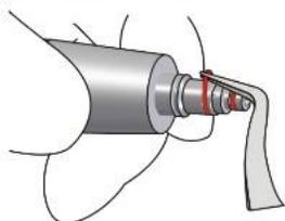
Замените O-образное кольцо на месте соединения наконечника с насадкой, смажьте соединение каплей масла для наконечников и равномерно распределите его.
