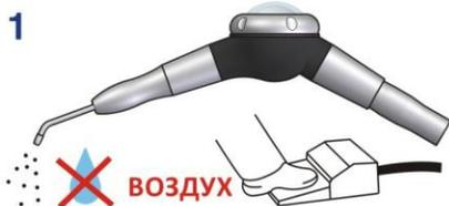
После удаления очищающего порошка из резервуара, просушите потоком воздуха насадку от остатков порошка и воды.
